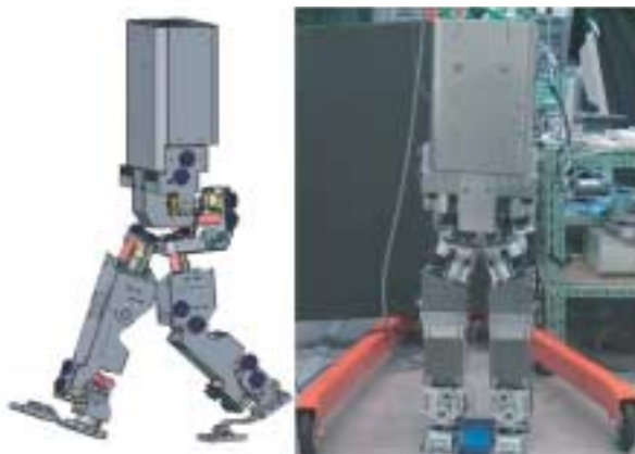
図5 二重球面股関節を持つヒューマノイドロボット
