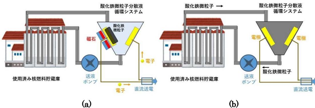
図 2 使用済み核燃料で発生するガンマ線を利用する場合の発電の構想図
