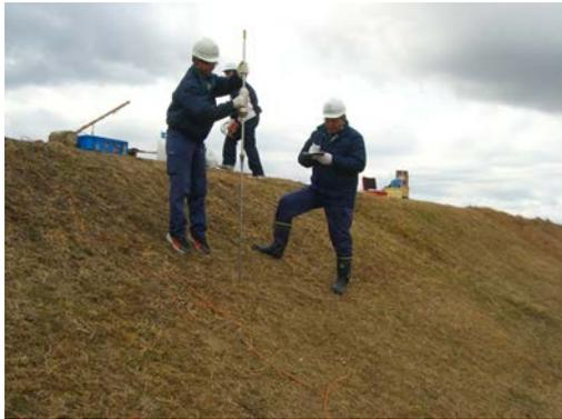
写真 4.3.4 簡易動的コーン貫入試験の様子
