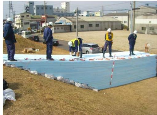
図 4.3.10 表面波探査における起振
