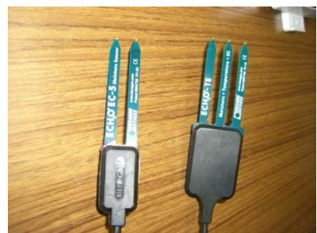
写真 3.4.1 誘電率式土壌水分センサー
