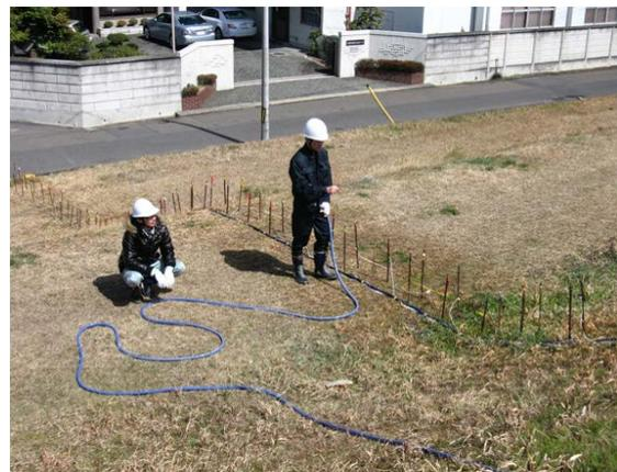
図 4.2.3 散水実験状況 (左：比抵抗モニタリング測線、右：散水状況)
