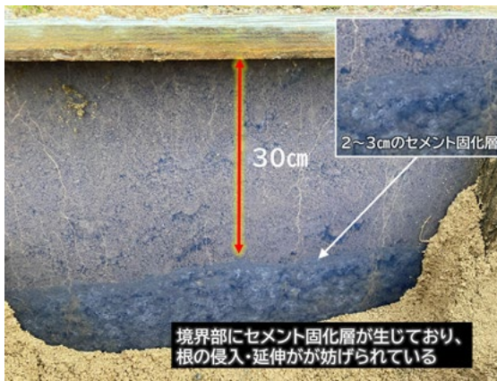
写真2 未改良路盤 (G-30CN) の根系
