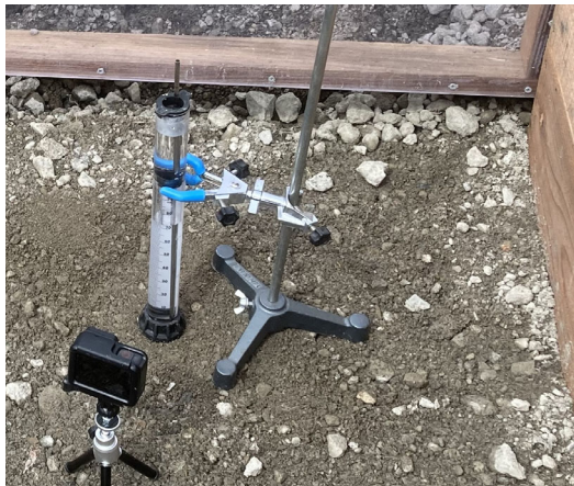
写真9 原位置透水試験の様子
