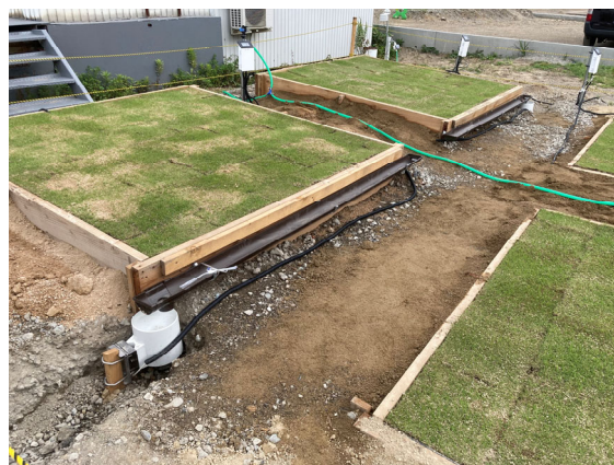
写真8 表面流出計測用の雨樋と雨量計
